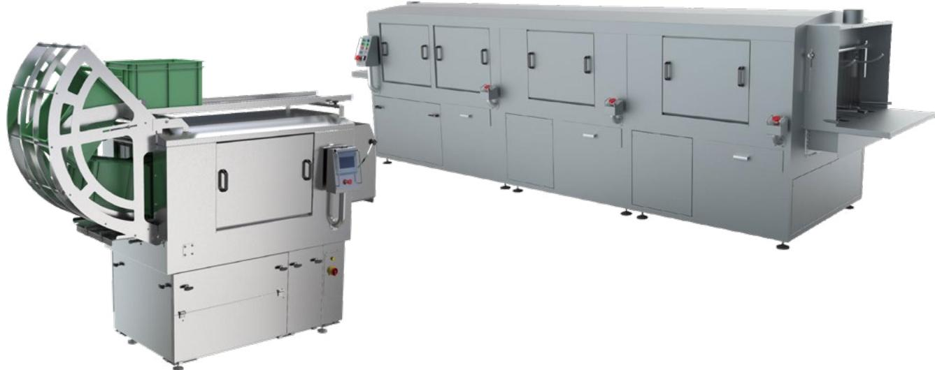
Предназначены для эффективной мойки и дезинфекции оборотной пластиковой тары. Тоннельная конструкция машины вкупе с высокопроизводительными насосами, распыляющими моющий раствор через форсунки, автоматическое дозирование моющих средств и поддержание температурного режима моющего раствора в резервуаре основной мойки позволяют добиться высокой производительности без ущерба качеству самой мойки.
